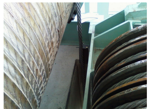
Abb 2: Sensor zu Positionsmessung
