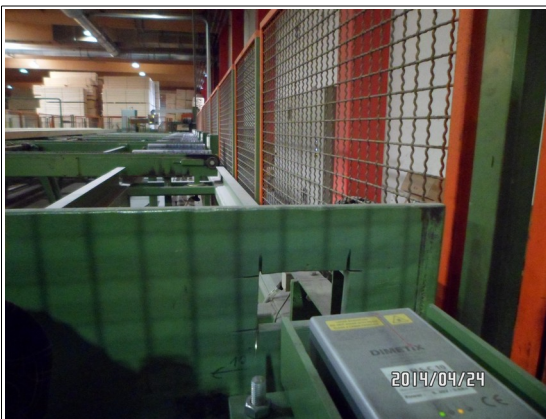
Abb 1: Dimetix Laser misst stimmseitig auf die angeschnittene Holzfläche
