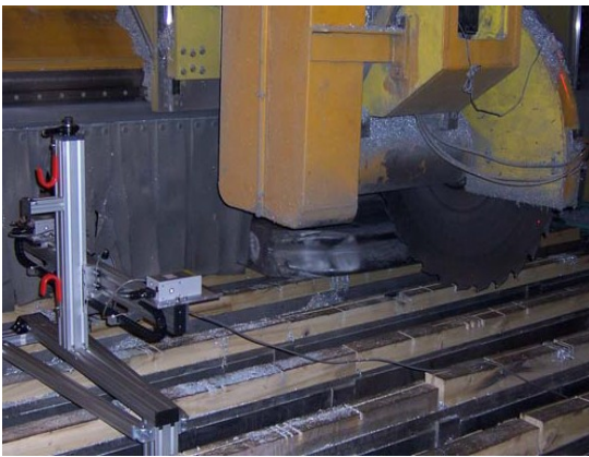
图 1: 安装了 Dimetix 激光测距传感器的龙门锯
