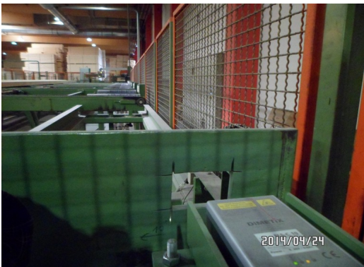
图 1: Dimetix 激光测距传感器正测量木材表面
