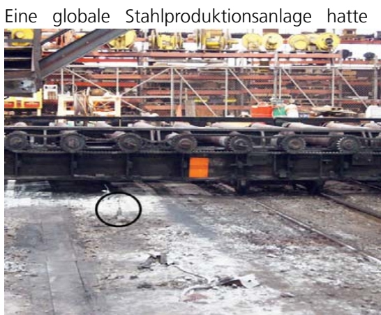
Abb 1: Zieltafel für Sensor am Transportwagen montiert
