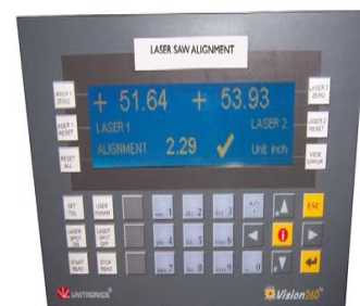
Abb 2: Steuerung mit Toleranzanzeige
