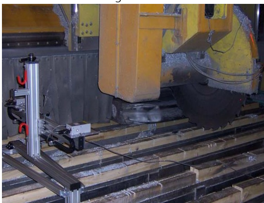
Abb 1: Sägeblatt und Laser Sensor
