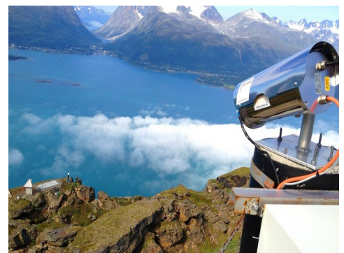
Abb 2: Gesteinsüberwachung mit Dimetix Laser Sensor
