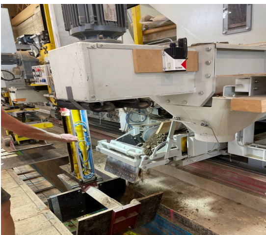
Abb 1: Position des Dimetix Sensors zur Höhenmessung des gestampften Lehms
